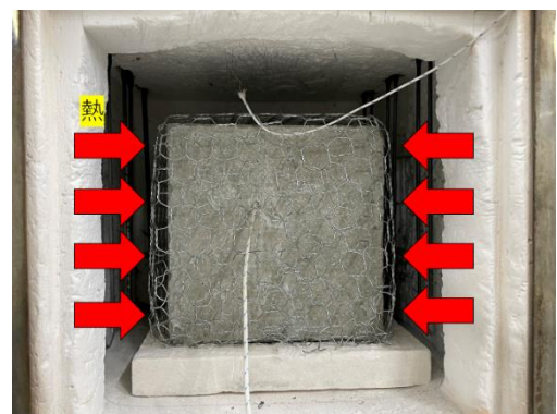
図 3 爆裂による炉内破損防止の様子
